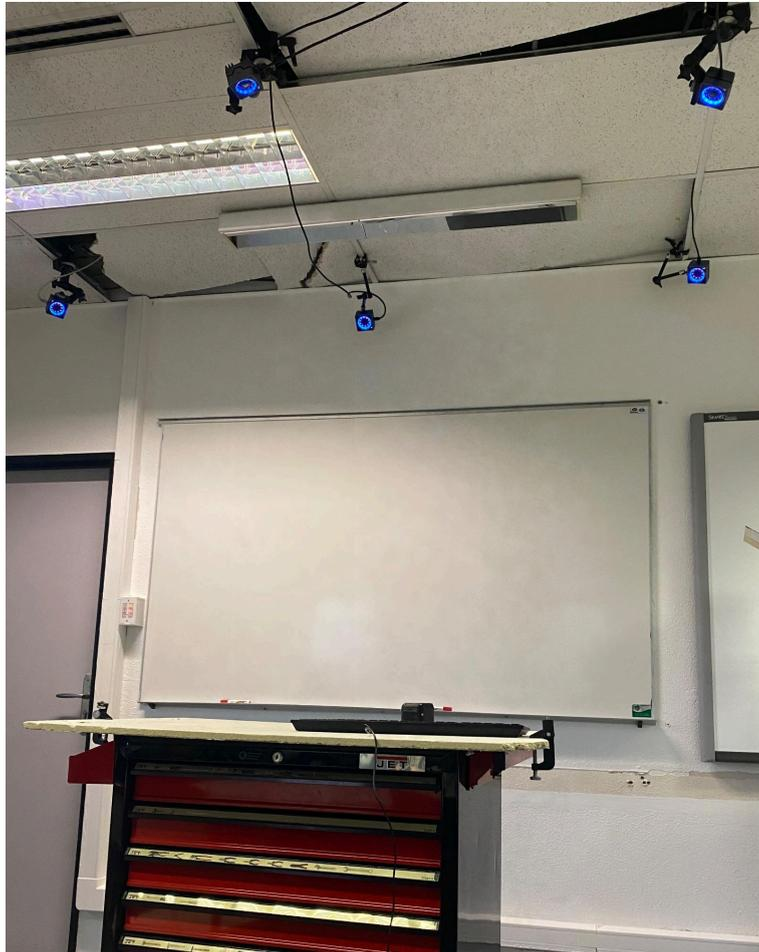
Figure 2 : set up de optitrack, clavier et cube
