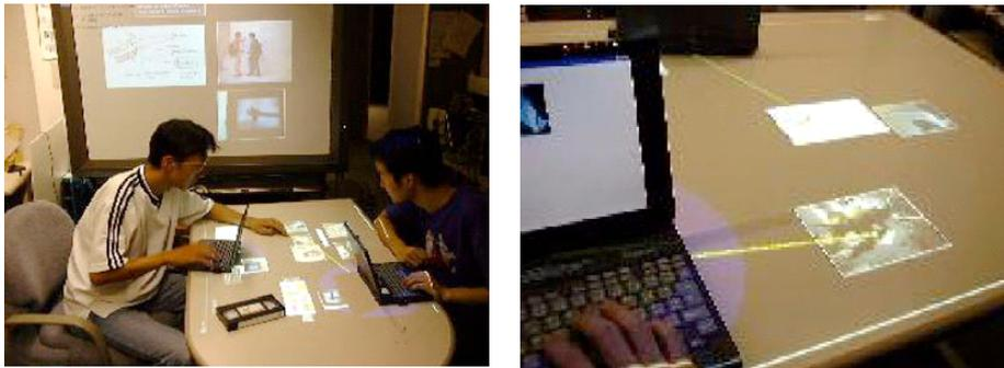
Figure 4. Les surfaces augmentées de (Rekimoto et al., 1999). L'utilisateur transfère des objets numériques entre son ordinateur portable dont la position est détectée par un système de vision, et une table. A droite, un "anchored link" matérialise le prolongement de la souris du portable sur la table.
