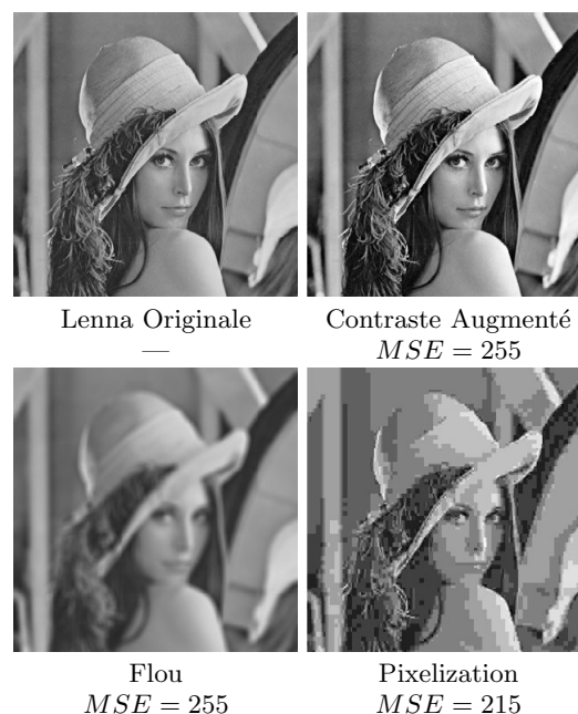
Figure 3: évaluation de l'image Lenna avec la détection d'erreur
