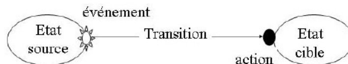
Figure 11 : exemple d'utilisation du formalisme FSM (finite state machine) [Bourguet 02]
