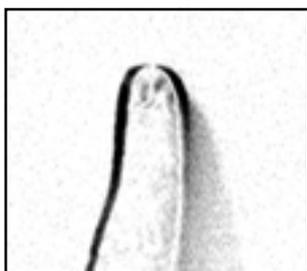
Figure 2 : Différence entre deux images successives du déplacement latéral d'un doigt. Noter la difficulté d'en déduire une position de pointeur dans le sens horizontal.
