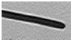
Figure 6: Interférence à la frontière d'un trait noir. Ce phénomène crée un mode dans l'intensité lumineuse claire.
