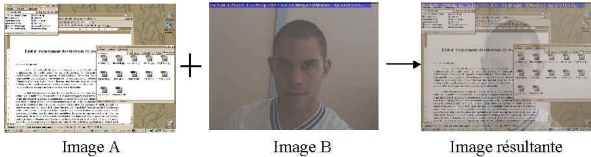
Figure 6 : Fusion de l'image de l'interface et d'une image vidéo.
