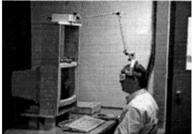
de suivi de la tête informe le système de la position du point d'observation. L'image générée est calculée en permanence pour correspondre au point de vue courant. Un tel système met en œuvre à la fois la stéréoscopie (port de lunettes) et la parallaxe par mouvement. Sur le plan interactionnel, on assiste à un fort couplage entre la position d'observation et l'image générée.
