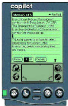
Figure 1. 7 : Le ContextNotePad rétro-éclairé l'écran sur détection de lumière ambiante faible.
