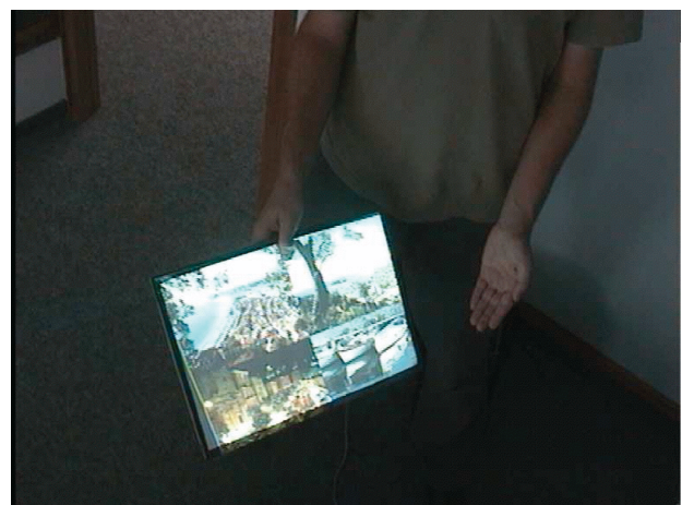
Figure 42. Projection d'une interface sur une surface déplaçable par un utilisateur avec le système Personal Display Surface.
