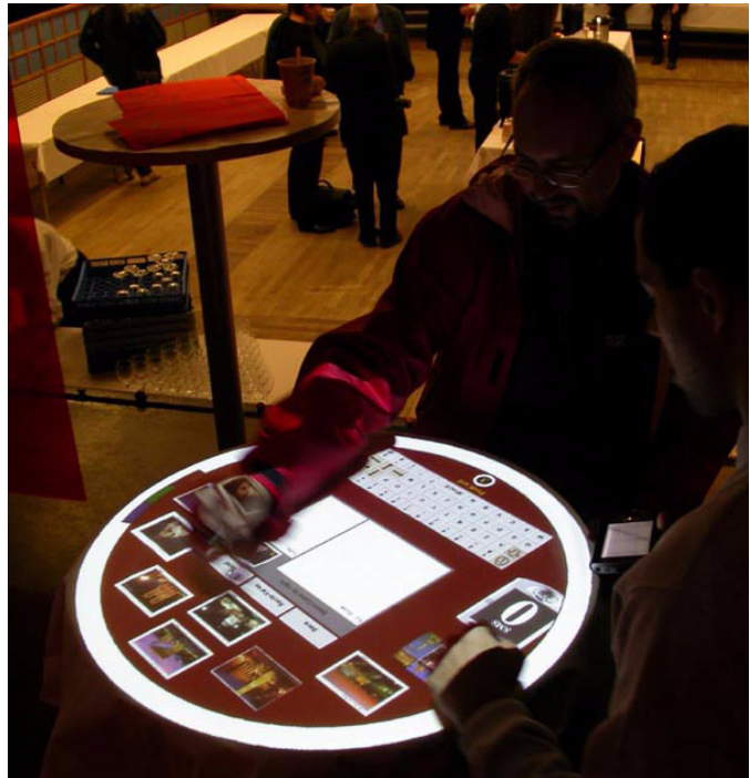
Figure 39. Interface rotative du prototype table Gloss. En cliquant devant lui sur la zone blanche située autour de la table l'utilisateur peut orienter l'interface en face de lui
