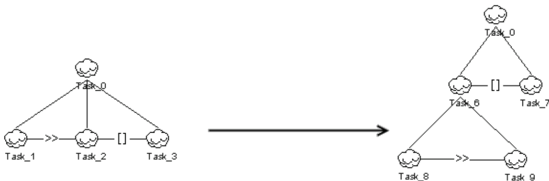
Figure.15 Schéma d’arbre des tâches à gauche, conforme la structure CTTe ; à droite conforme à la structure imposée par K-MADe . La tâche 6 est abstraite.
