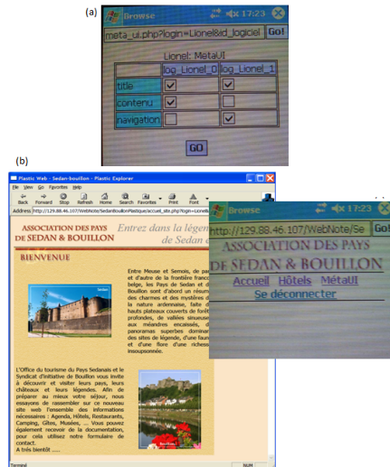
Figure 9.4 : Le site Sedan-Bouillon en version distribuée entre les ressources d'interaction du PC et du PDA. En haut de la figure, le panneau de contrôle servant de méta-IHM de négociation en sorte que l'utilisateur exprime ses souhaits de redistribution de l'IHM de Sedan-Bouillon.
