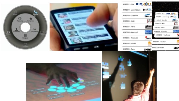
Figure 9.1 : Déclinaison du menu. De gauche à droite et de haut en bas : le menu Wavelet sur téléphone mobile [FRA 10], Menu polymorphe 2D/3D, MTM (Menu MultiTouch) pour table interactive multipoints [BAI 08], Shadow Reaching : sélection de cible avec son ombre [SHO 07].
