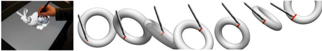
FIGURE 8: Dessin en direct sur des modèles 3D avec un contrôle automatique de la caméra. (A gauche) Dessin sur un modèle 3D avec un écran à stylet. (A droite) Le point de vue de la caméra est modifié pour que le stylet reste perpendiculaire à la surface du modèle 3D pendant le dessin. Cela permet de continuer à dessiner sur des surfaces non visibles depuis le point de vue initial et de conserver la même précision tout au long du dessin.
