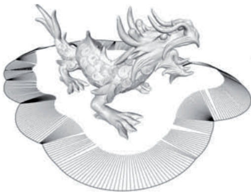
FIGURE 2.12 – Comparaison des trajectoires de la caméra pour les techniques Hovercam [158] et Smooth HoverCam [162] : Les discontinuités du mouvement de la caméra avec HoverCam sont visibles au niveau des angles où la caméra s'arrête. Les discontinuités concernant l'orientation sont visibles via les espacements irréguliers des vecteurs le long de la trajectoire.
