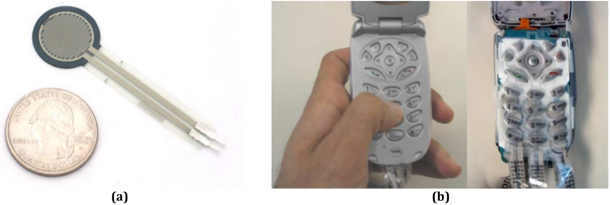
Figure 3.14 – (a) Résistance à détection de force (b) Prototype de clavier avec capteurs de pression, issue de [31].
