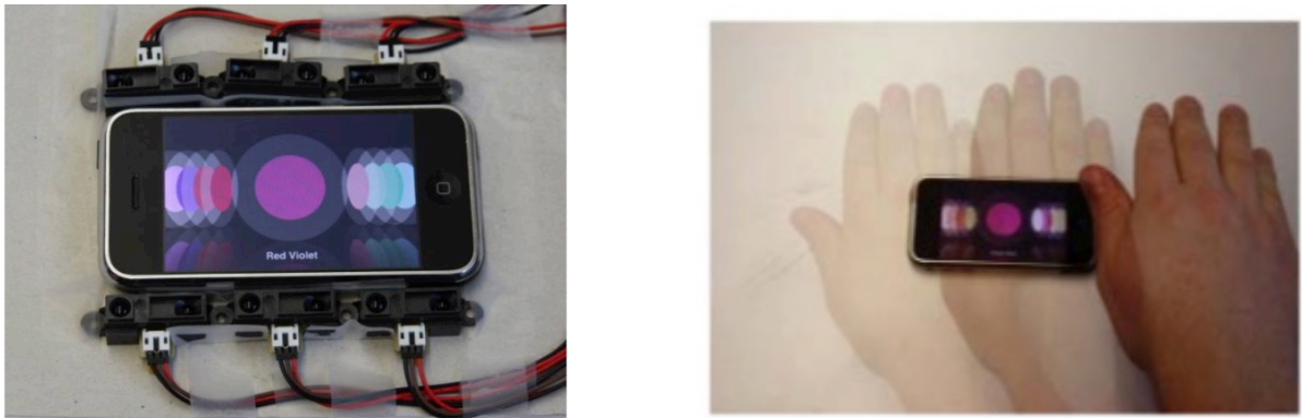
Figure 3.16 - HoverFlow : interaction autour du dispositif grâce à des capteurs infrarouges. Issues de [73].
