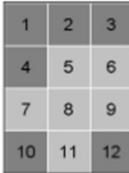
Figure 3.3 – Zones difficilement accessibles (zones sombres) avec le pouce de la main qui tient le dispositif mobile dans le cas d'un droitier. Issue de [66].
