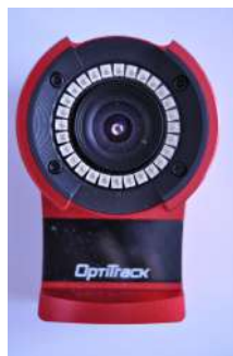
FIGURE 4.3 – Une caméra Optitrack Flex 13. On note le cercle de LEDs infrarouges autour de l'objectif.
