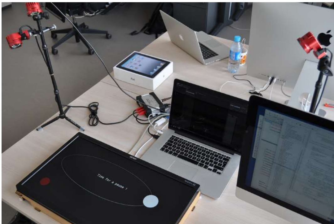
FIGURE 4.1 – Photo de notre système faible latence. L’ordinateur portable est connecté aux caméras (rouges, en haut à gauche et en haut à droite) et exécute le logiciel de suivi. Les données de position du doigt sont transmises via le réseau au PC principal (en bas à droite). Celui-ci calcule le retour visuel et l’affiche sur l’écran posé horizontalement sur le bureau.
