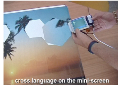
Figure 2.1.2.4 : Systèmes multimodaux en sortie exploitant plusieurs écrans incluant des mini-écrans pour augmenter des objets physiques (comme une pièce de puzzle ou l'aiguille de ponction d'un chirurgien).
